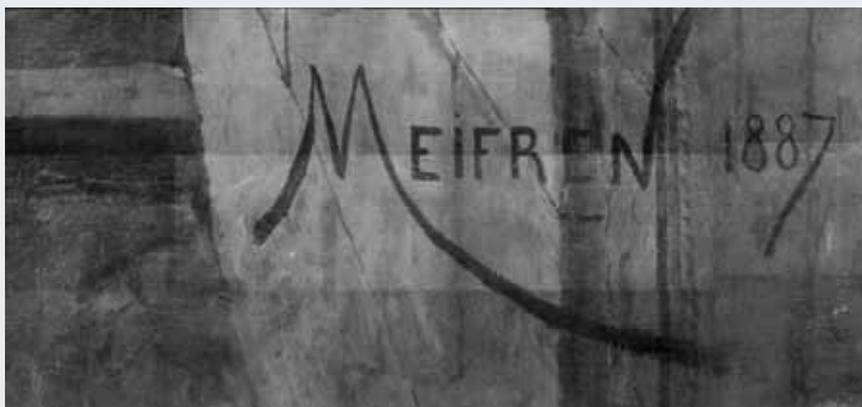
Imagen obtenida con reflectografía IR de la zona de la firma y fecha.
